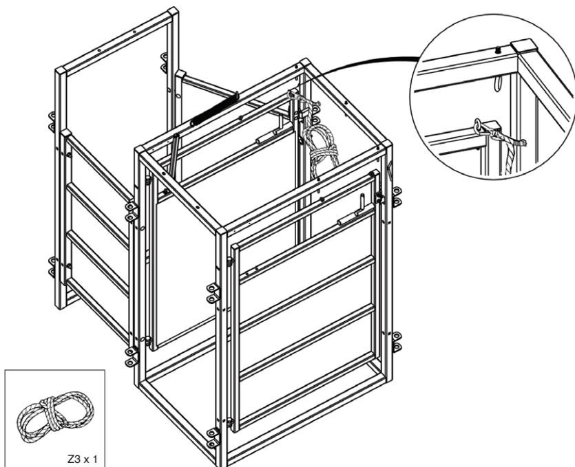
**7** Faites passer la corde dans le boulon à œil central du châssis principal.
